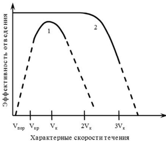
**Рис. 7.47.** Схема зависимости процесса отведения рыб от скорости потока (по Павлов, Пахоруков, 1983) 1 – РЗУ с проницаемой преградой, 2 – РЗУ с непроницаемой преградой. Остальные обозначения как на рис. 7.46
