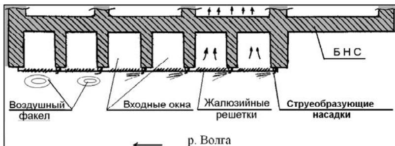
**Рис. 7.22.** Схема жалюзийного рыбозащитного устройства водозабора Тверской ТЭЦ-4
